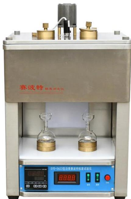
Этот прибор в основном состоит из ванны, регулятора температуры ванны и таймера.
