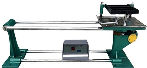
Он подходит для формования метчиком при приготовлении образцов цементного раствора.
