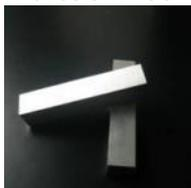
Это два блока для фиксации образца
