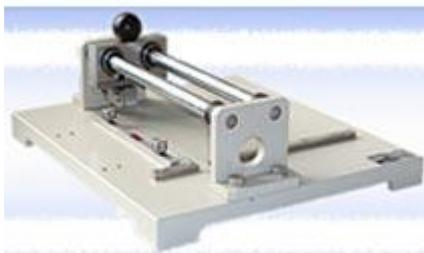
**Тест на раздавливание кромки гофрированного картона / резак для образцов клея**
